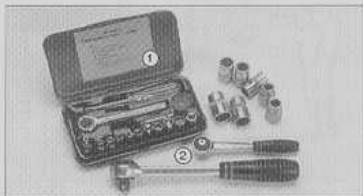
Do prac w komorze silnika oraz pod pojazdem okaże się potrzebny zestaw kluczy nasadowych (1) z grzechotką (2) o główce 1-calowej i końcówkami 10-32 mm. Zakup kompletu kluczy jest znacznie tańszy niż pojedynczych elementów. Zestaw z grzechotką o główce 1 cala przydaje się również do prac we wnętrzu pojazdu, gdzie elementy są mocowane wkrętami z rowkiem krzyżowym, prostym i typu torx oraz śrubami o rozmiarach 6-13 mm
