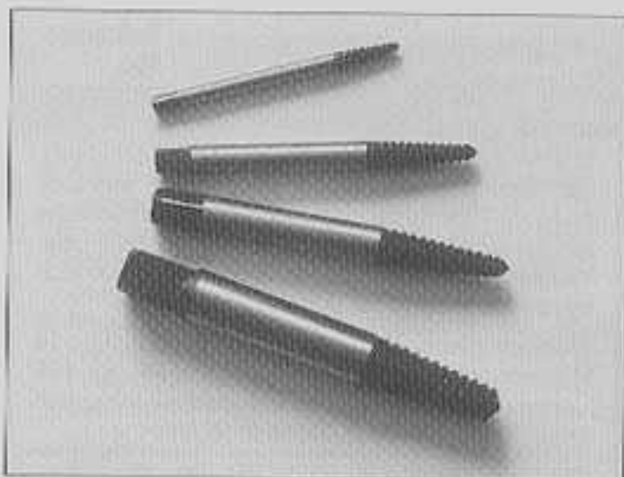
Za pomocą tych przyrządów można wykręcić wiele urwanych śrub z ich otworów. Mocuje się je w uchwycie gwintownika
